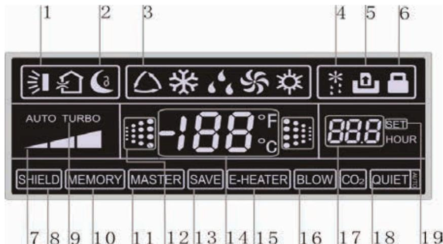
Fig. 2 Écran LCD du contrôleur filaire
